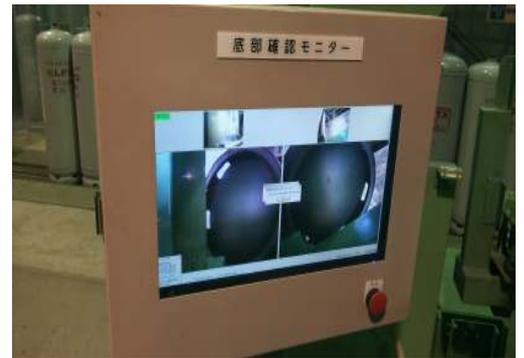
底部確認モニターを刻印機側に設置すると、第二次外観検査を効率よく、2カメラにより、死角をなくし、鮮明な画像にて合否を判断できます。1点に作業を集中させることにより、合理化を促進できます。
